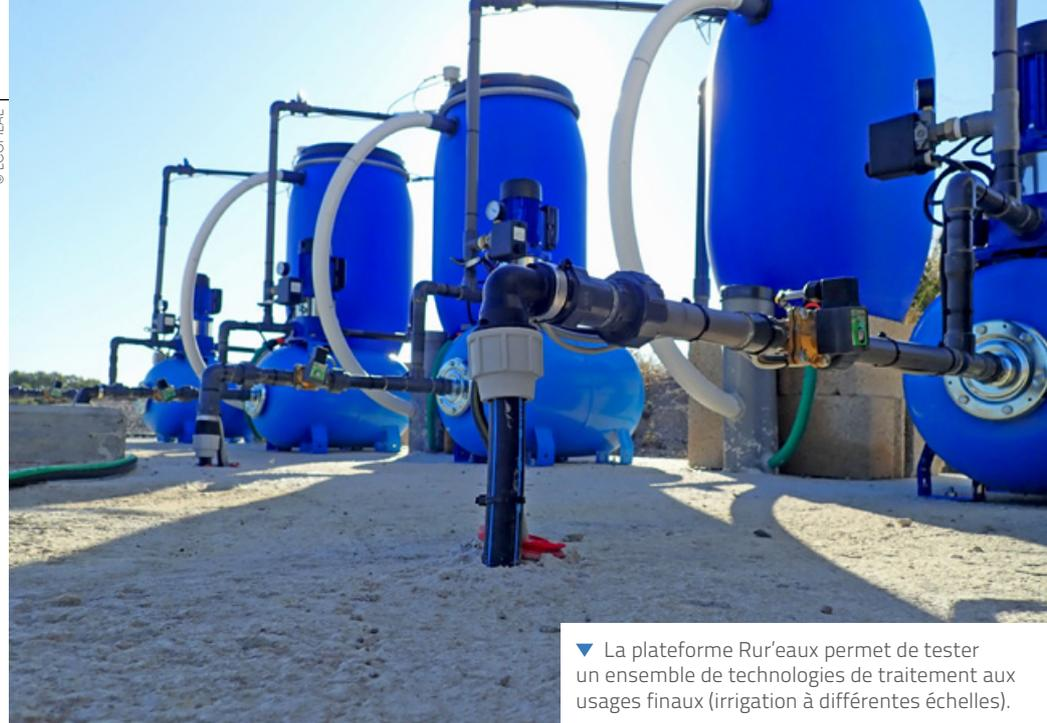
▼ La plateforme Rur'eaux permet de tester un ensemble de technologies de traitement aux usages finaux (irrigation à différentes échelles).
